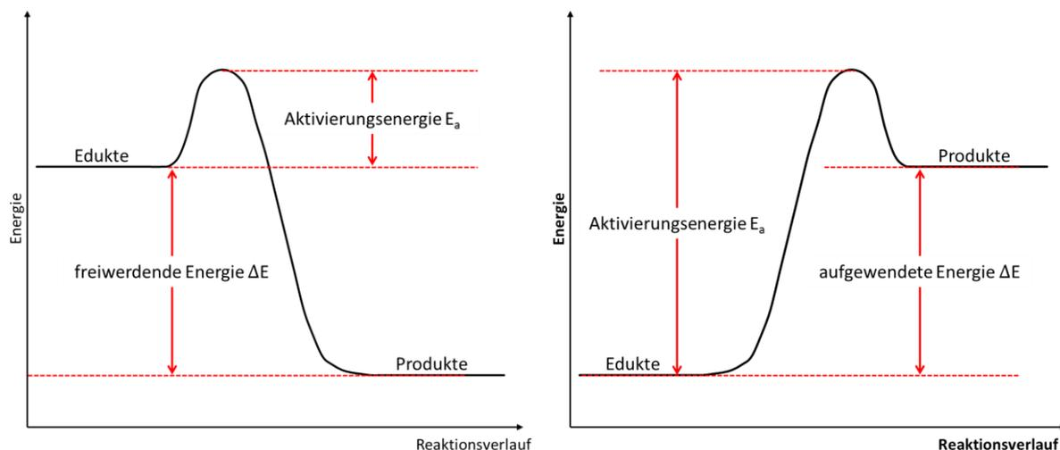
Ein **Katalysator** ist ein Stoff, der an einer Reaktion teilnimmt, die Aktivierungsenergie dabei herabsetzt und die Reaktion beschleunigt. Er liegt nach der Reaktion wieder wie vor der Reaktion vor, wird also nicht verbraucht.
